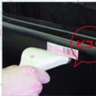
パーツの溶接部位にシール貼付
