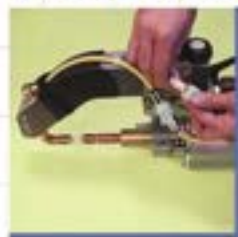
アーム交換開始。 カプラはワンタッチで外せ、 水漏れ無し！！※1
