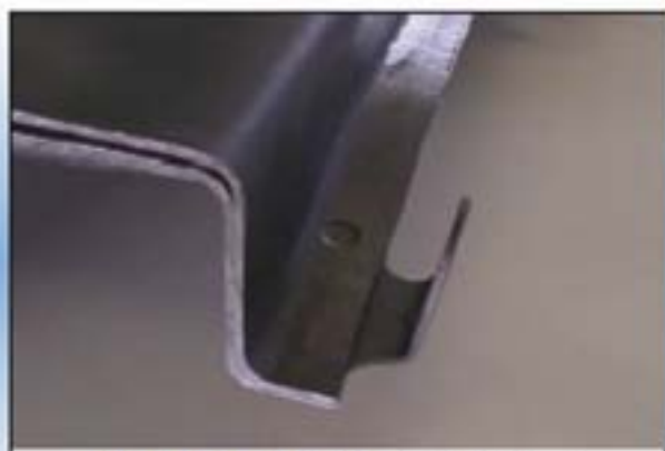
トヨタ/ガイア フロントサイドメンバー部 2+2mm 溶接条件設定溶接後、スプレー塗装
