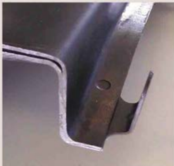
トヨタ/ガイア フロントサイドメンバー部 2+2mm YSI-24D溶接条件設定溶接後、スプレー塗装。
