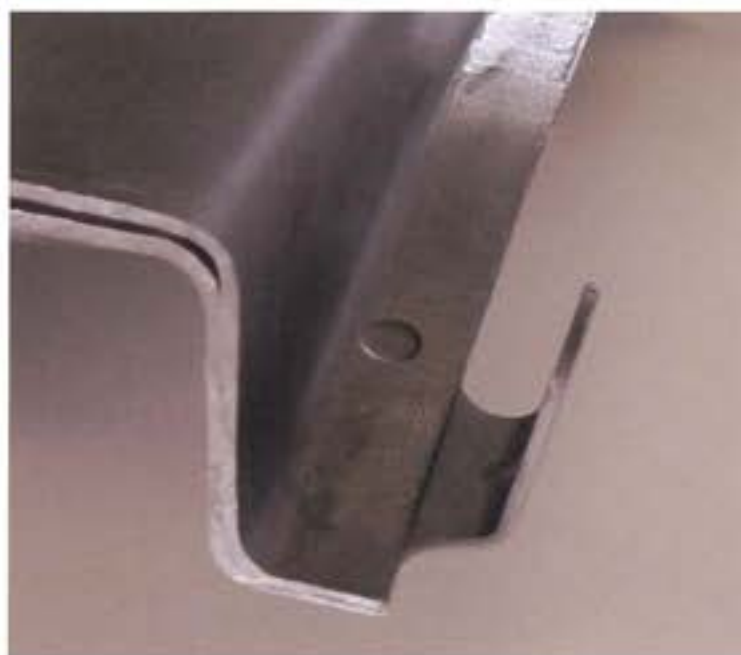
トヨタ/ガイア フロントサイドメンバー部 2+2mm YSI-24D溶接条件設定溶接後、スプレー塗装。
