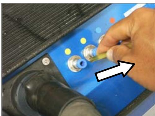
もう片方の二次ケーブルの水チューブ(黄色のライン)を溶接機本体から抜いてください
