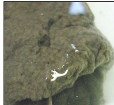
スケール(藻のようなもの)が発生して、冷却水が循環しにくくなります
