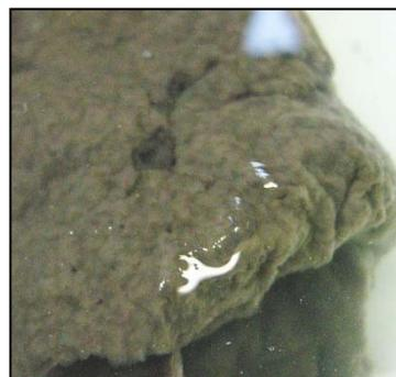
スケール(藻のようなもの)が発生して、冷却水が循環しにくくなります
